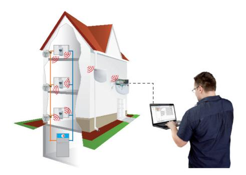
Il sistema **AMR** (*Automatic Meter Reading*) è un sistema concepito per consentire di centralizzare i consumi rilevati da ciascuno strumento di misurazione tramite apposite antenne - collocate nelle parti comuni dello stabile contabilizzato - che memorizzano i dati ricevuti via radio.
